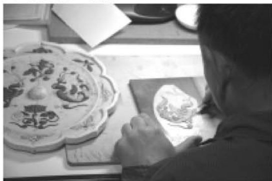
① 模型を参考にして、蠟で各部品の原形を作る。 （今回は複数枚の鏡を製作するため この方法を用いた。）
