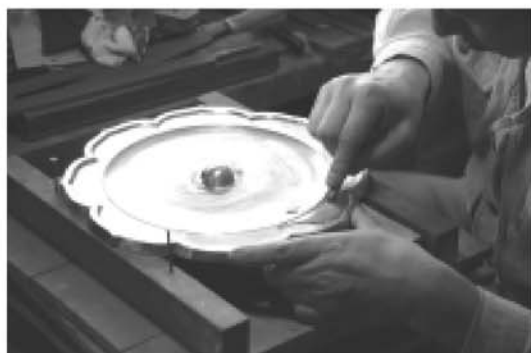
⑤ 鑢、砥石などで研磨して仕上げる。
