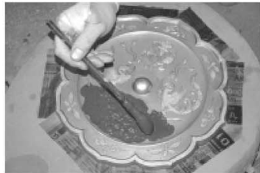
② 表型鑄肌面に台鏡を乗せ、肌真土を付ける。
