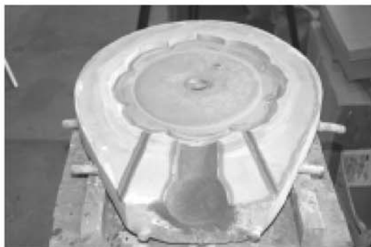
③ 湯口と上がり（排ガス孔）を彫り込んで 鋳型（裏型）の完成。
