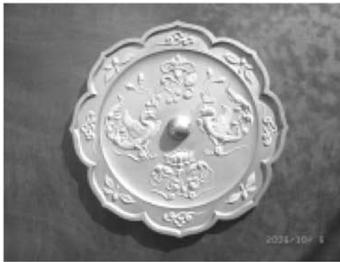
① 台鏡全体に蠟皮膜をし、その上に蠟部品を貼り付けた状態。
