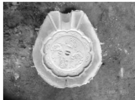
④ 焼成して脱蠟した後、ヒビなどを修正し、再焼成した状態。
