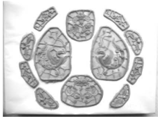
④ 粘土型に軟化した蠟を押し込み、蠟部品を写し取る。
