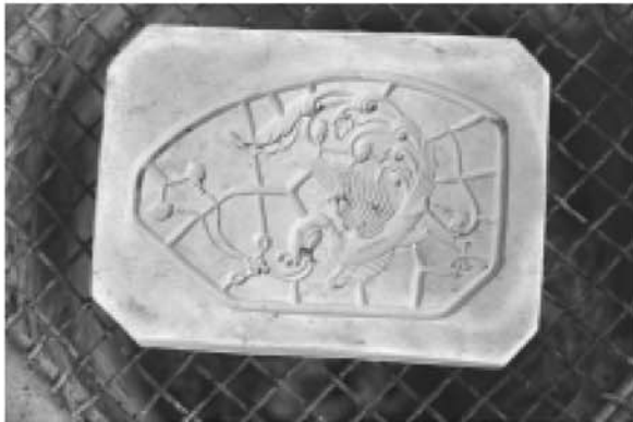
③ 蠟部品原形に粘土をかぶせて写し取り、補強のための枠を彫り込み、焼成する。
