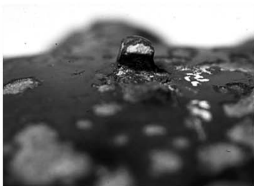
(写真5) 全羅南道大谷里出土青銅八珠鈴 (韓国国立中央博物館所蔵) 裏面中央の破断した鈕の断面は半丸形で中心部は銀白色。その外に腐蝕層がある。
