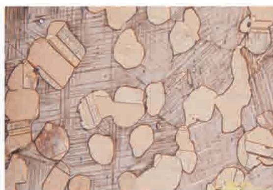
巻頭写真 36 Cu-22Sn 熱間鍛造材を焼入れ後、冷間鍛造した金属組織
