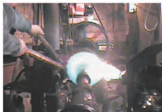
巻頭写真 56 スピニング加工されるボウル 写真 55 の可視画像：金一雄工房
