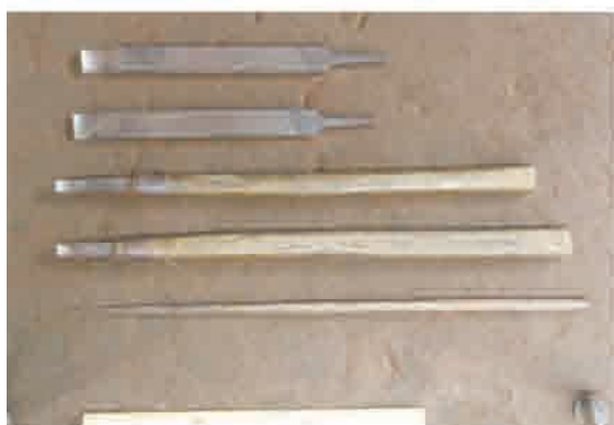
巻頭写真 31 ALA FORGE 工房 (K.R.SUKU) 下からガイド棒、鋼の切削工具、鋳を加工した工具。
