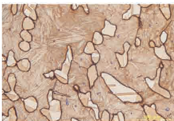
巻頭写真 35 Cu-22Sn 熱間鍛造材の金属組織 (焼入れ後)
