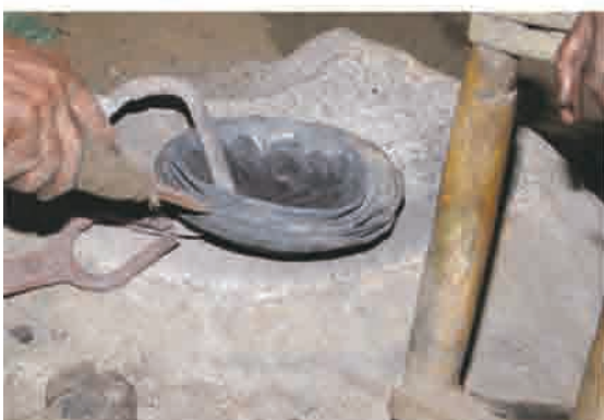
巻頭写真 7 APPUNI 工房 6枚重ねて錠を熱間鍛造する。
