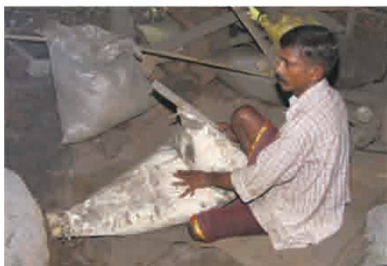
巻頭写真 21 APPUNI 工房 牛革の手鞆。他に、手回し送風機もある。
