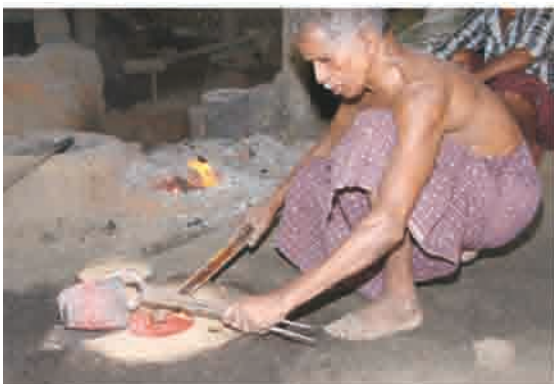
巻頭写真 3 APPUNI 工房 錫 22%前後の高錫青銅を窪みに流して円板を作る。
