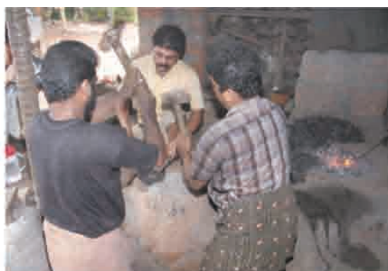
巻頭写真 26 ALA FORGE 工房 (K.R.SUKU) 石台の上で2人で平板ゴングを熱間鍛造する。
