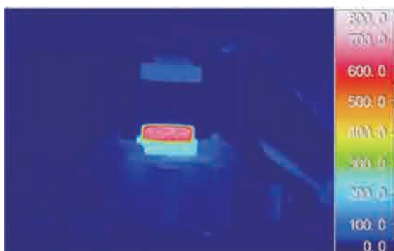
巻頭写真 61 熱間加工（プレス機による口縁絞り） の熱画像（加工される部分：平均温度 660℃）
