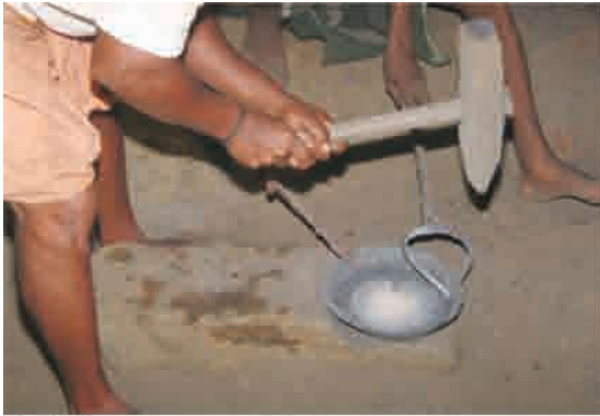
巻頭写真 9 APPUNI 工房 石の台に当てて碗の角の内側を木槌で打つ。
