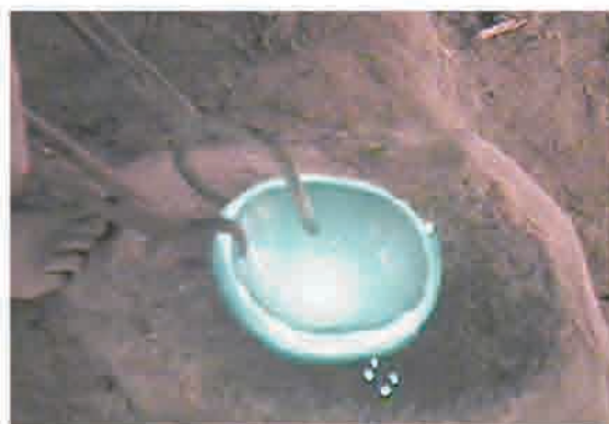
巻頭写真 40 熱間鍛造されるボウル 写真 39 の可視画像：APPUNI 工房
