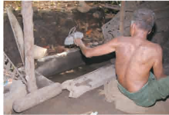
巻頭写真 10 APPUNI 工房 加熱した碗を伏せて水槽に入れ焼入れする。
