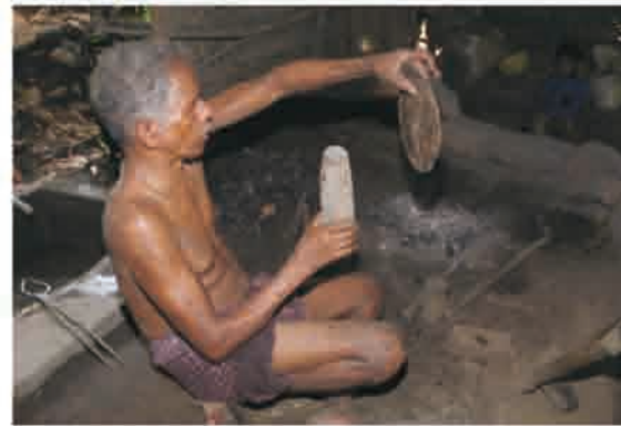
巻頭写真 12 APPUNI 工房 平板ゴングは焼入れ後、響きの良い位置を探す。
