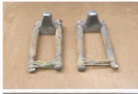
巻頭写真 16 APPUNI 工房 熱間鍛造に使う両手持ちの鉄ハンマー。
