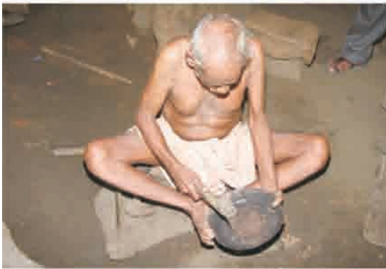
巻頭写真 11 APPUNI 工房 焼入れ後、鉄台に当てて冷間鍛造で形を均す。
