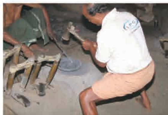
巻頭写真 8 APPUNI 工房 6枚重ねて1人で中央部分を熱間鍛造する。
