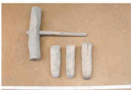
巻頭写真 19 APPUNI 工房 シンバルの中央の突起（ヘソ）を打ち出す木の杭。
