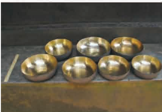
巻頭写真 15 APPUNI 工房 碗の内面は研磨するが、外面は研磨しない。
