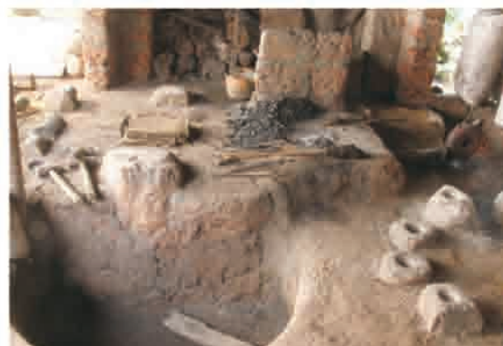
巻頭写真 22 ALA FORGE 工房 (K.R.SUKU) 3 面が壁の工房。右はシンバルのヘソ出し用の石台。
