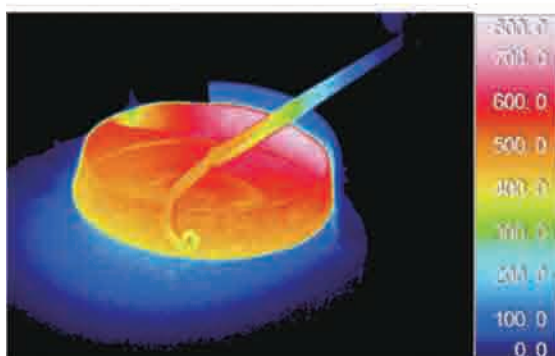
巻頭写真 49 熱間鍛造の熱画像 (加工される部分：平均温度 690℃、反対側 420℃)
