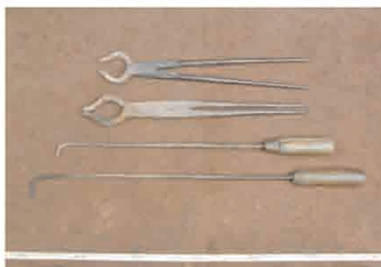
巻頭写真 30 ALA FORGE 工房 (K.R.SUKU) 挟みと加熱炉で製品を回転する L 字鉄棒。
