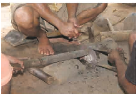
巻頭写真 27 ALA FORGE 工房 (K.R.SUKU) 円板を垂直に立てて、回しながら円板の側面を叩く。
