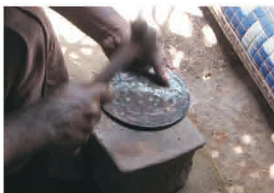
巻頭写真 28 ALA FORGE 工房 (K.R.SUKU) 焼入れ後、冷間鍛造して形を整える。
