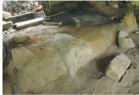
巻頭写真 2 APPUNI 工房 中央が石台。左奥が焼入れ水槽。右奥が加熱炉。
