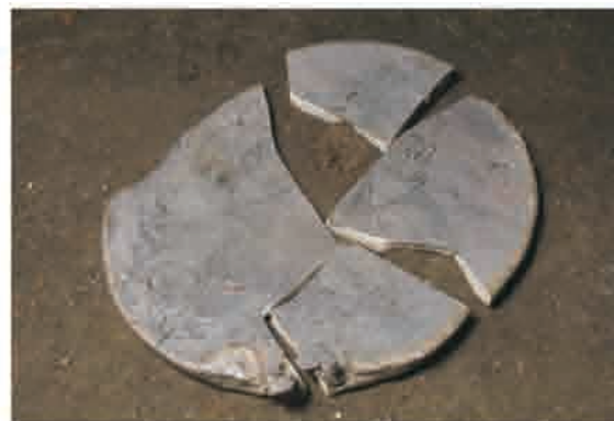
巻頭写真 4 APPUNI 工房 錫 22%の高錫青銅は割れ易く、破断面は銀白色。
