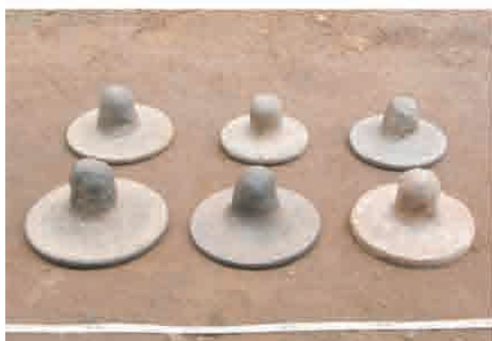
巻頭写真 29 ALA FORGE 工房 (K.R.SUKU) 円板を鋳造する窪みを作る土製スタンプ。
