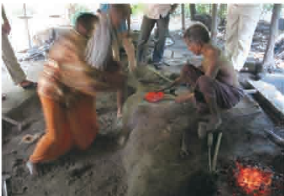
巻頭写真 5 APPUNI 工房 右下が加熱炉。石台の上で2人で熱間鍛造する。
