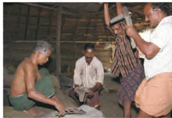
巻頭写真 6 APPUNI 工房 円板を2枚重ねて3人で熱間鍛造する。
