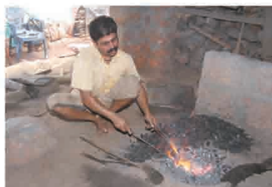
巻頭写真 24 ALA FORGE 工房 (K.R.SUKU) 左手で製品を挟み、右手の L 字鉄棒で回転する。
