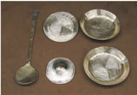
巻頭写真 13 APPUNI 工房 焼入れ後、切削した製品。焼入れで黄金色に変わる。
