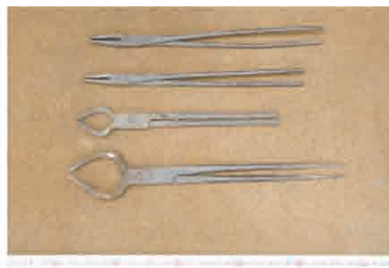
巻頭写真 18 APPUNI 工房 熱間鍛造で製品を挟む挟み。
