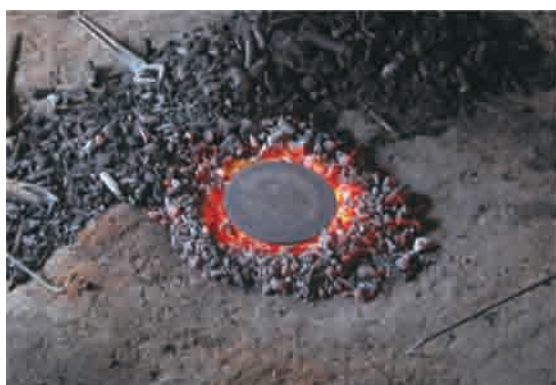
巻頭写真 25 ALA FORGE 工房 (K.R.SUKU) 小さく切った炭火を製品に被せて加熱する。
