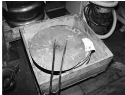
写真8 小出シンバル製作所の焼入れ 1mmほどの薄い高錫青銅円盤を焼入れ し、冷間加工する。
