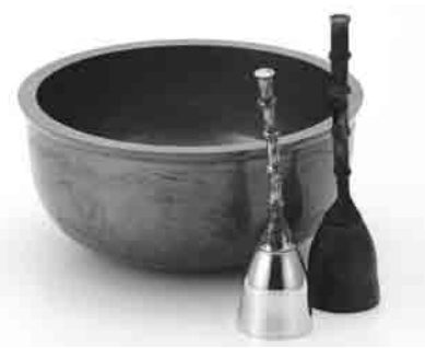
写真9 りんよ工房のおりんと呼び鈴 共に錫20数%の高錫青銅で鑄造し、加熱 徐冷している。(写真提供 白井克明氏)
